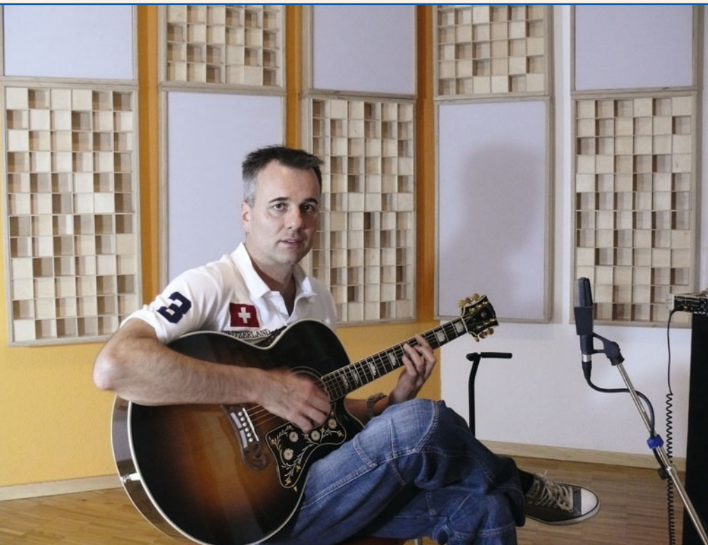
Jochen Sachse im halbtrockenen Raum vor dem für den Praxistest verwendeten Mikrophon, einem AKG C414, eingestellt auf Kugelcharakteristik.
