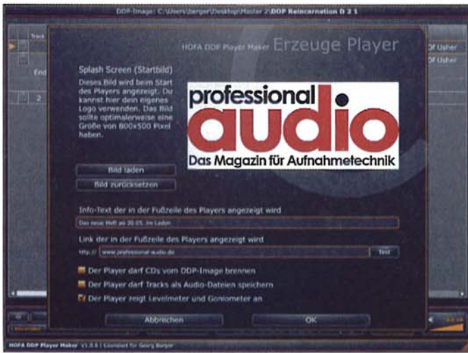
Der Player Maker erlaubt das Erzeugen einer Player-Applikation, die fest an das geladene DDP Image gebunden ist. Diverse Optionen erlauben dem Anwender, den Custom-Player mit verschiedenen Features auszustatten oder sie auszuklammern.
